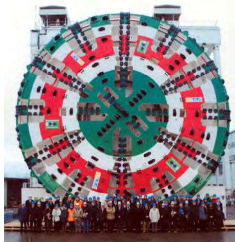
Figura 1. TBM EPB "Martina", \varnothing = 15,62 m
