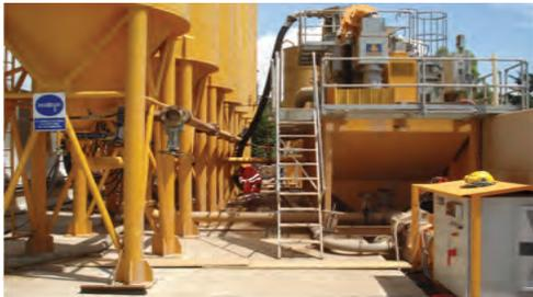
**Figure 13. Pompa KBKT per il rilancio della bentonite nello scavo, in questo caso collegata alla vasca con agitatore per il ricircolo, posto sotto l'impianto di dissabbiamento (Metro C – Saos, Roma)**
