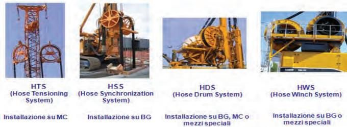
Figura 6. I quattro tipi di tensionatori delle manichette idrauliche
